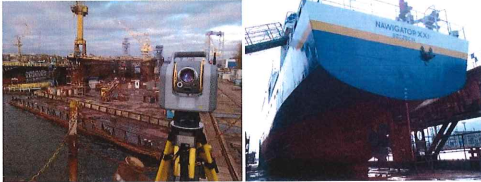
Rys. Pomiary Total Station w nachylonych i dynamicznych układach odniesienia, źródło: publikacja 7.
