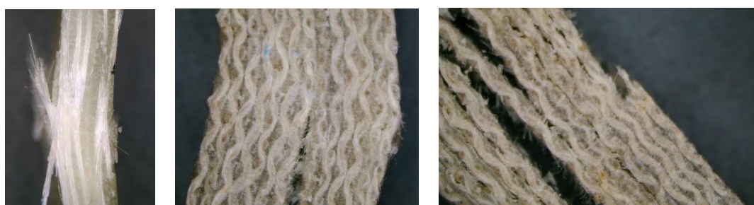
Rys. 54. Przykładowo w skali mikro: próbka S1_3 Z oraz K6_3 Z i Km6_5 Z po badaniu wytrzymałości na zginanie statyczne
