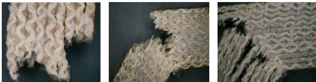
Rys. 55. Przykładowo w skali mikro: próbka Km4_3 oraz Km5_4 i Km6_3 po badaniu udarności metodą wg Charpy'ego
