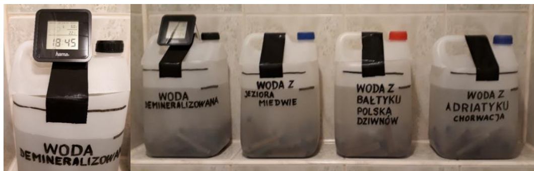
Rys. 48. Serie po 25 próbek do badań udarności materiałów kompozytowych metodą Charpy'ego przeznaczonych do trzymiesięcznego starzenia kompozytów w ośrodkach (2), (3), (4), (5) - widok pojemników z próbkami zanurzonymi w wodach
