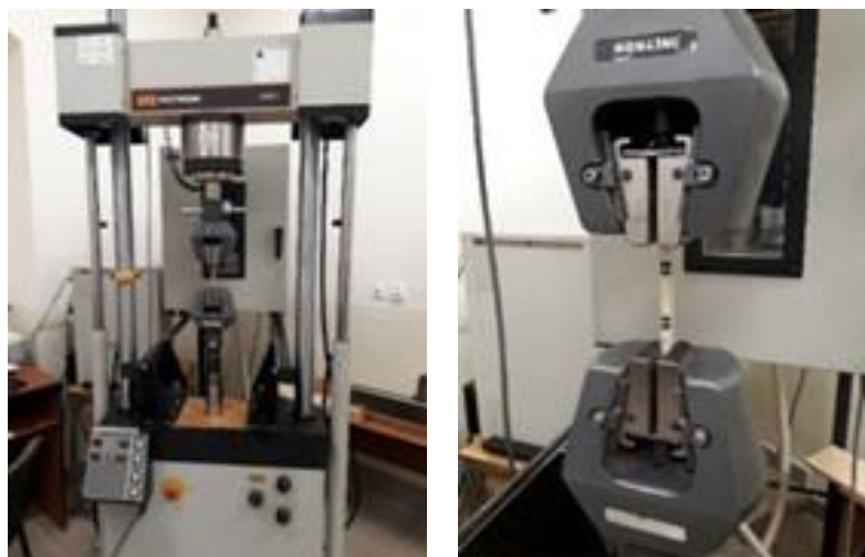
Rys. 43. Maszyna wytrzymałościowa INSTRON typ 8501 - badanie wytrzymałości materiałów na rozciąganie
