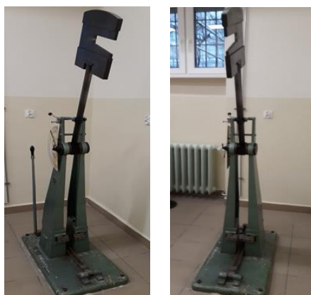
Rys. 51. Młot wahadłowy firmy VEB Werkstoffpruefmaschinen Leipzig o maksymalnej energii uderzenia do 300 [J], do badania udarności materiałów metodą wg Charpy'ego
