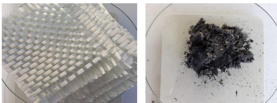
Rys. 40. Pozostałość wzmocnienia po zakończonej próbie palności kompozytów: GFRP (tkanina szklana typu E) oraz HFRP (popiół tkaniny 100% konopnej)
