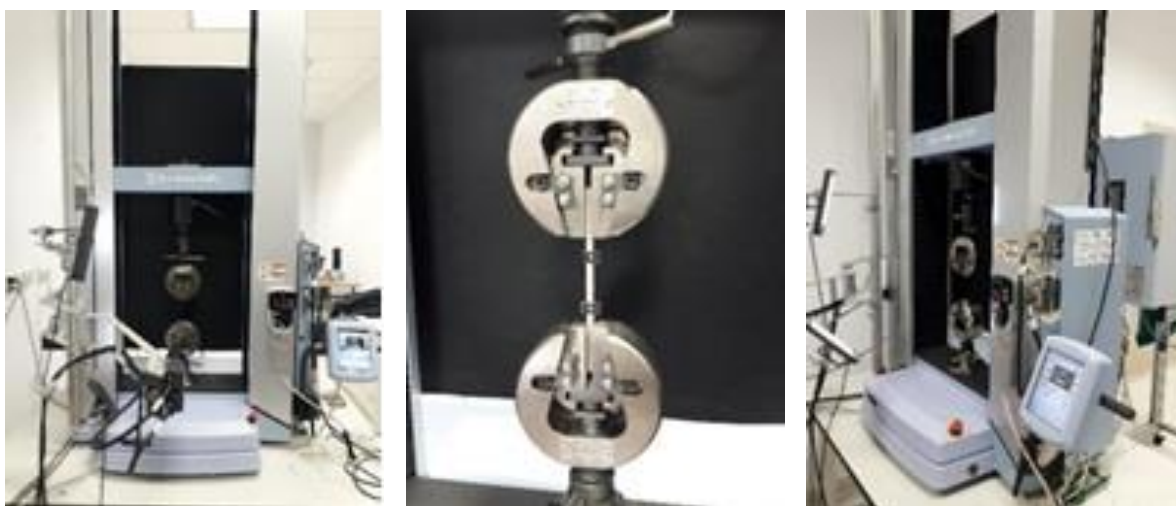
Rys. 42. Maszyna wytrzymałościowa SHIMADZU typu AG-X plus -badanie wytrzymałości materiałów na rozciąganie
