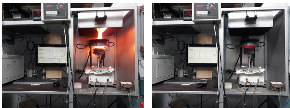
Rys. 38. Próba palności kompozytu GFRP: początek i koniec próby
