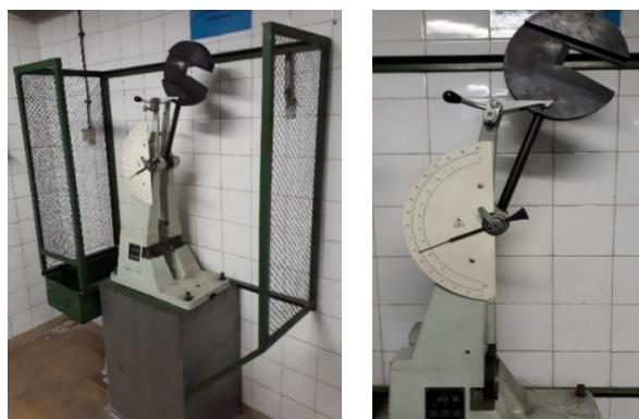
Rys. 50. Młot wahadłowy firmy VEB Werkstoffpruefmaschinen Leipzig-Betrieb des VEB „Fritz Heckert” o maksymalnej energii uderzenia do 50 [J], - badanie udarności materiałów metodą wg Charpy'ego
