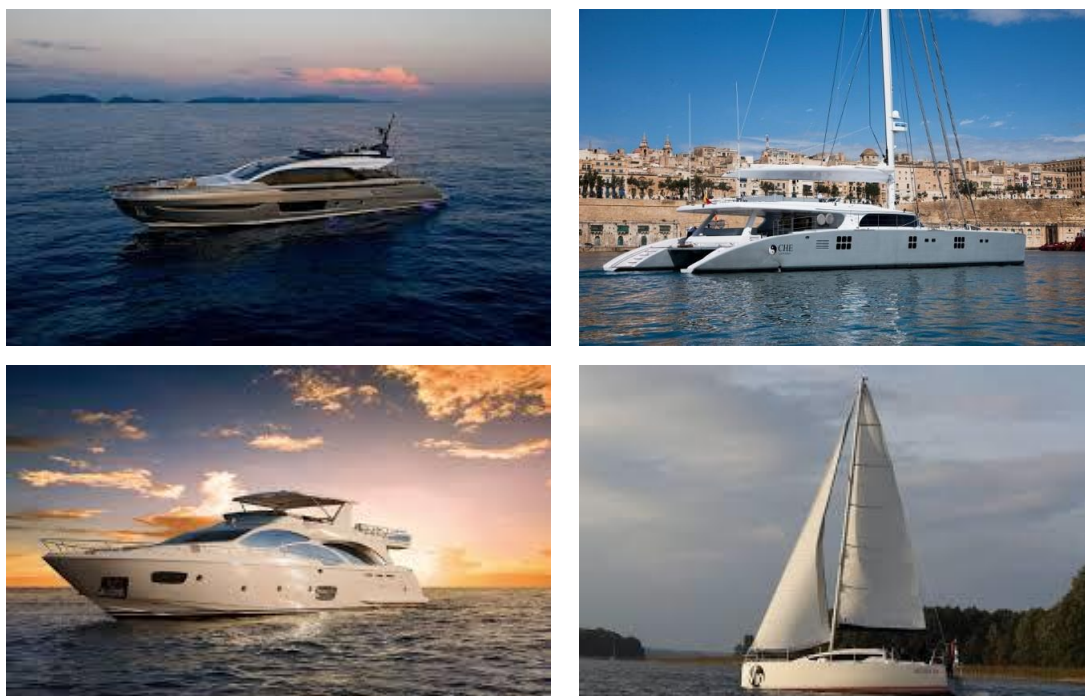
Rys. 1. Jednostki pływające wykonane z kompozytu polimerowego wzmocnianego GF lub CF (opracowanie własne, 2019, w powiązaniu z {1})
