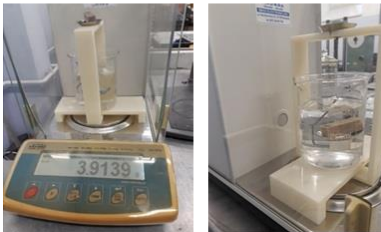
Rys. 33. Waga elektroniczna Typ XA 340 (Z.M.P. RADWAG) doposażona w indywidualny niezależny układ ramowy (na rys. po lewej stronie np.: badana próbka K5_5)
