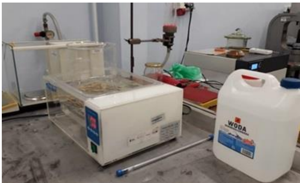
Rys. 35. Stanowisko do badań nasiąkliwości (absorpcji wody)
