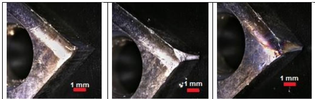
Rys. 20. Widok narzędzia w kolejnych stanach zużycia
