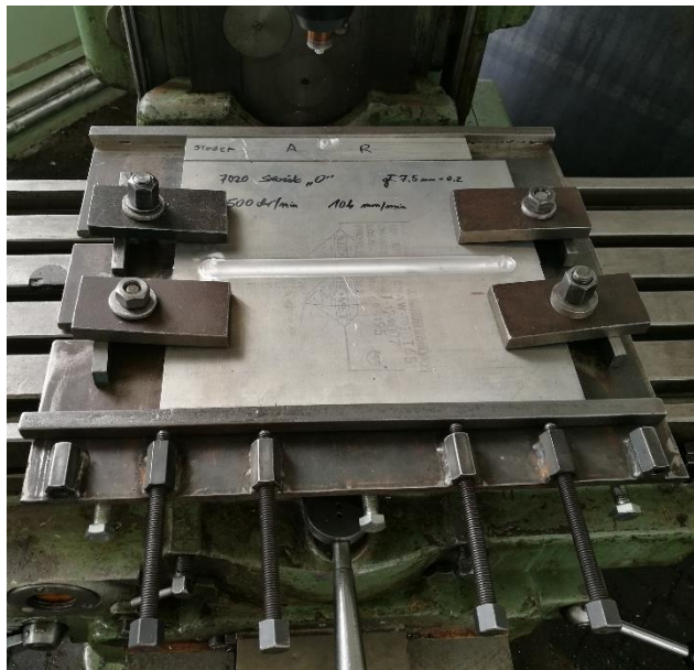
Ogólny widok stanowiska do zgrzewania metodą FSW oraz zestaw sztywnego mocowania zgrzewanych blach
