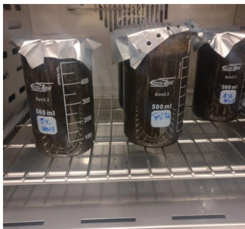
Rys. 4.15 Widok próbek w kompoście, w inkubatorze laboratoryjnym- kompostowanie w przyźnie wraz z dodatkiem cukrów prostych (melasa buraczana)
