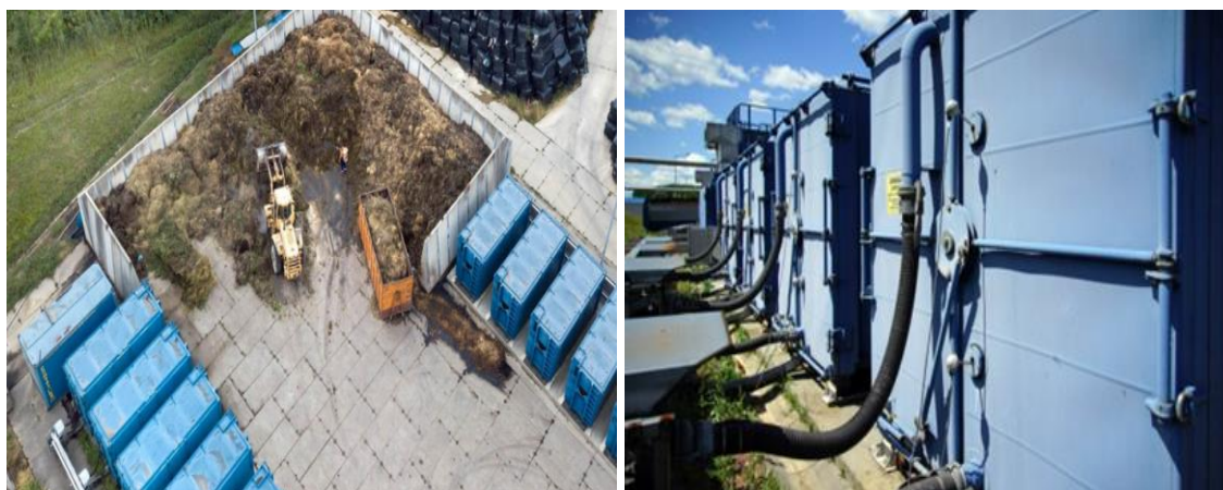
Rys. 2.8 Kontenery typu zamkniętego, w których znajduje się materiał organiczny przerabiany na kompost [157]
