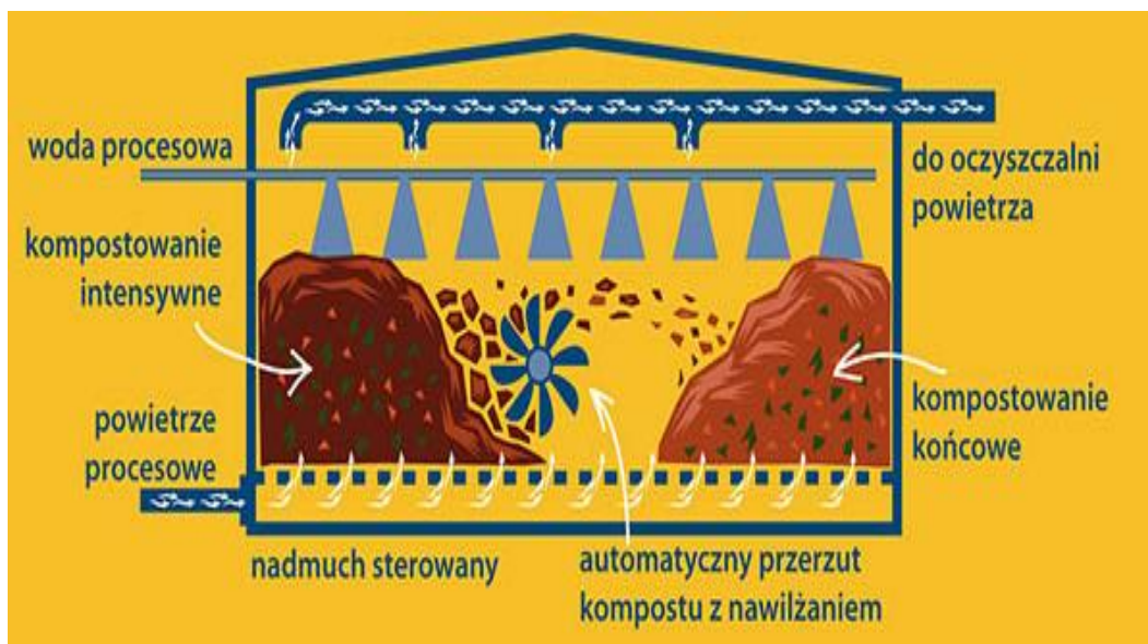
Rys. 2.7 System z reaktorem kompostującym [155]
